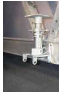
noga A v iztegnjenem in v poklopljenem položaju
