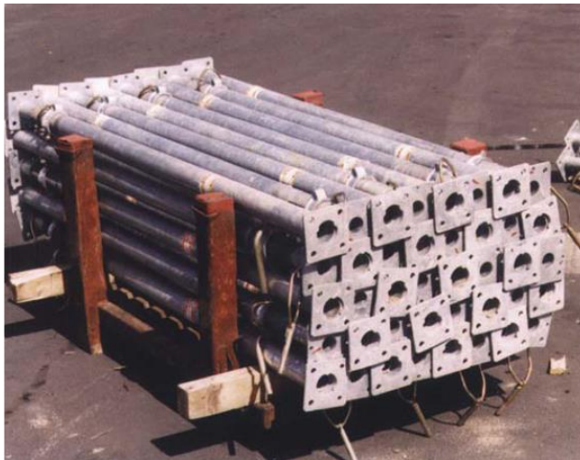
Slika 14: Primer čistih podpornikov
