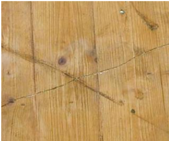
Slika 28: Primer praske na vezani plošči
