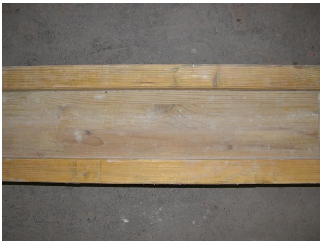
Slika 2: Primer betonskega mleka na lesenem nosilcu
