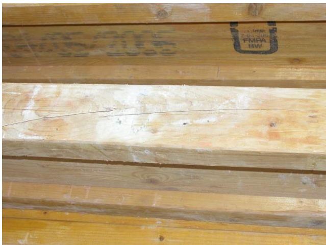
Slika 6: Primer praske na lesenem nosilcu
