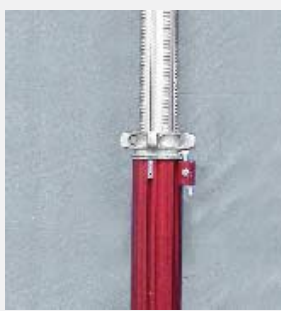
Varovalo matice za zaklep višine mega podpornika
