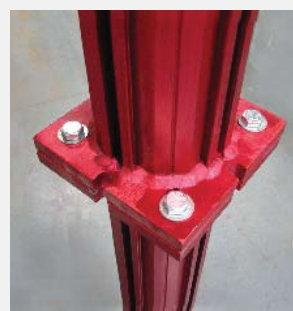
Spajanje osnovnih plošč z vijaki, ko postavimo en podpornik na drugega
