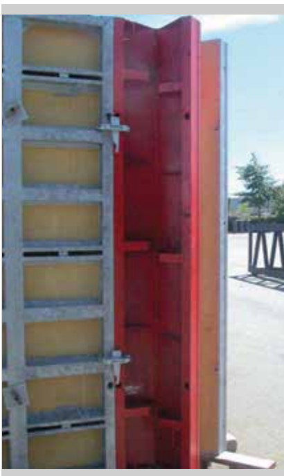
▲ Detalj kuta sastavljen iz unutarnjeg i vanjskog kutnog elementa
